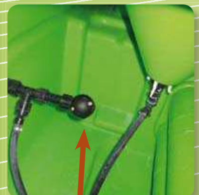
Buse rotative pour rincer la cuve.
