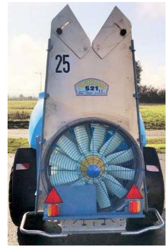
S21 – Double turbine vergers voûte droite
