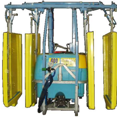
S21 - Panneaux récupérateurs
