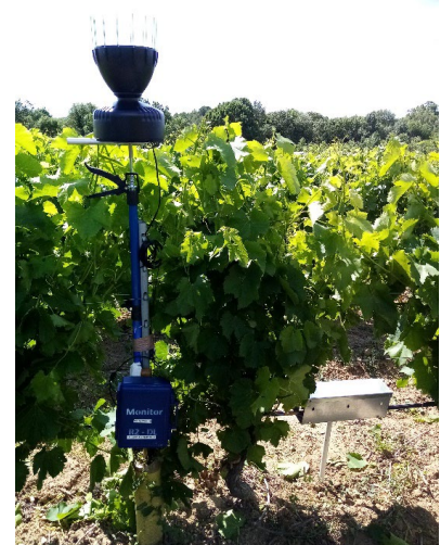
Sites tensiométriques avec pluviomètre et compteur sur vigne
